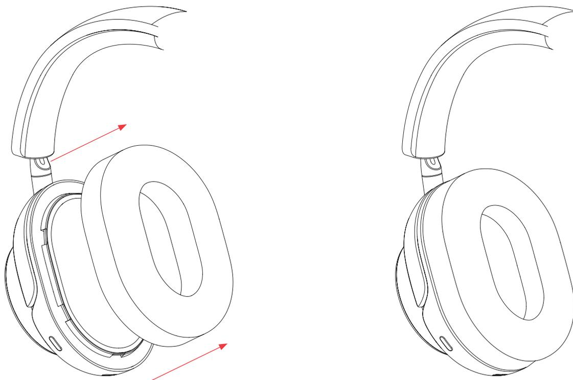
**Pour retirer les coussinets d'oreille :** Tirez doucement sur les coussinets de l'intérieur de l'écouteur. Les boutons-pression seront libérés.
